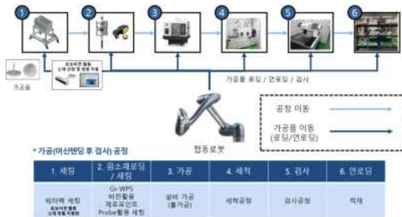
[ 협동 로봇 2D 비전 기반 머신텐딩 정밀가공 후 검사 공정 흐름도 ]
